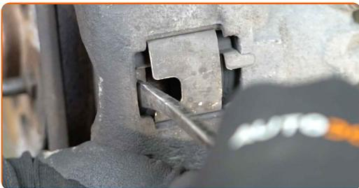
**9** Ta bort låsstiftets låsklämma. Använd en rundtång.
