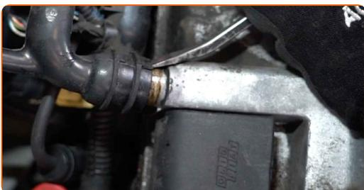
**8** Lossa anslutningselementen till spjällhusventilen. Använd en kofot.
