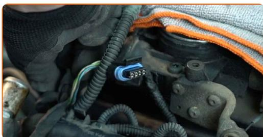
**19** Fäst vevhusventilationsslangen i motorshöljet till vänster.
