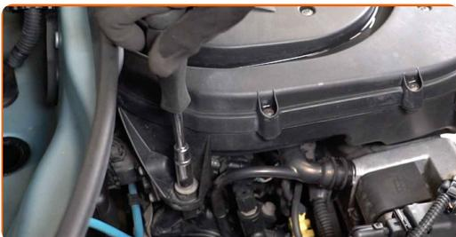
4 Ta bort luftfilterhusets hållarfjäder.
