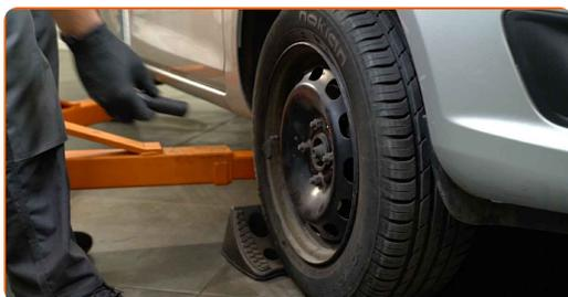
**2** Lossa på hjulmonterings bultar. Använd hjulmutterhylsor nr. 19
