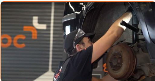
**21** Montera stötdämparfästet genom att använda mitthålet som vägledning.
