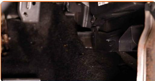
**4** Skruva loss fästena från skyddet till kabinfiltret. Använd Torx T20. Använd en spärrnyckel.
