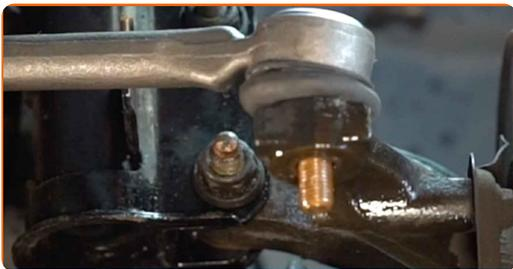
**17** Skruva åt fästande skruven som kopplar styrstagsände till styrspindeln. Använd hylsnyckel Nr15. Använd en momentnyckel. Dra åt den till 48 Nm vridmoment.
