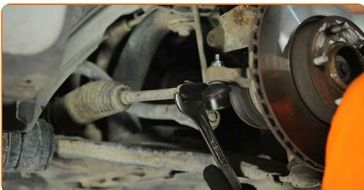
**19** Behandla fästningarna som kopplar styrstagsändan till styrspindeln. Använd kopparpasta.
