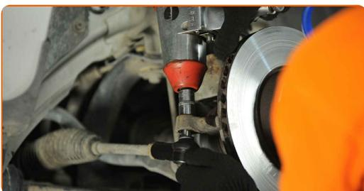
**18** Dra åt parallellstagsändens låsmutter. Använd kombinyckel Nr 24. Använd en momentnyckel. Dra åt den till 62 Nm vridmoment.
