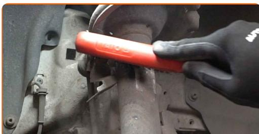
9 Skruva loss fästena som håller fast krängningshämmaren med stötdämparen. Använd hylsnyckel Nr17. Använd en spärrnyckel.
