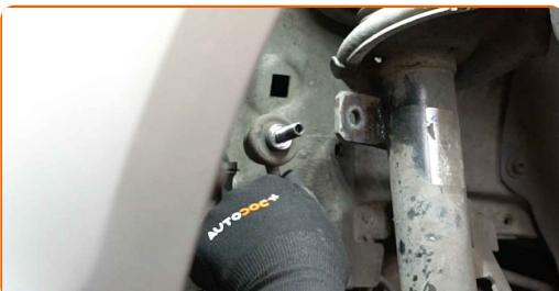
11 Rengör drivaxeln fäste. Använd en stålborste. Använd WD-40 aerosol.
