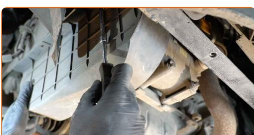
**16** Dra åt fästelementen på oljetrågets nedre lucka. Använd Torx T30. Använd en spärrnyckel.
