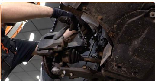
**21** Förse styrspindeln med stöd. Använd en hydraulisk domkraft.
