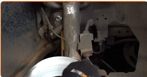
**18** Rengör fästena som anslutar stabilisatorn med fjäderbenet, och de som ansluter fjäderbenet till och kontrollspindeln. Använd en stålborste. Använd WD-40 aerosol.
