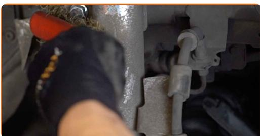
**19** Skruva loss muttern och avlägsna krängningshämmaren från stötdämparen. Använd hylsnyckel Nr15. Använd en spärrnyckel.
