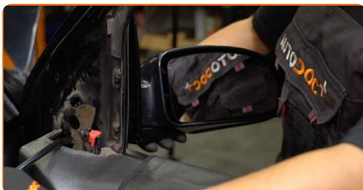
**10** Dra åt sidospegelelns skruvar. Använd hylsnyckel Nr10. Använd en momentnyckel. Dra åt den till 8 Nm vridmoment.
