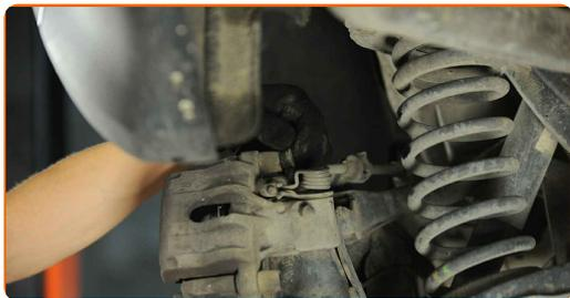
**25** Installera bromsokets spärrfjäder. Använd en plattmejsel.
