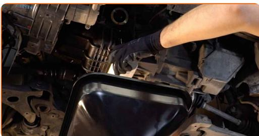
Utbyte: motorolja och filter – FORD Mondeo Mk4 Hatchback (BA7). Tips från AUTODOCs experter:
