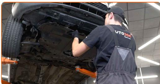
7 Sätta en spillolja behållare med minst 4 l kapacitet under dränering hålet.
