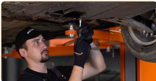
6 Ta bort locket till oljetråget. Använd hylsnyckel Nr10. Använd en plattmejsel. Använd en spärrnyckel.
