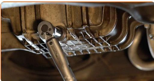
**17** Installera om oljetrågets nedre lucka. Dra åt fästelementen på oljetrågets nedre lucka. Använd hylsnyckel Nr10. Använd en spärrnyckel.
