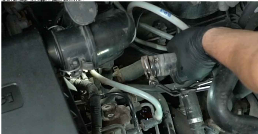
11 Rengör fästena på termostathusets lock. Använd en stålborste. Använd universalknötrensingspray.
