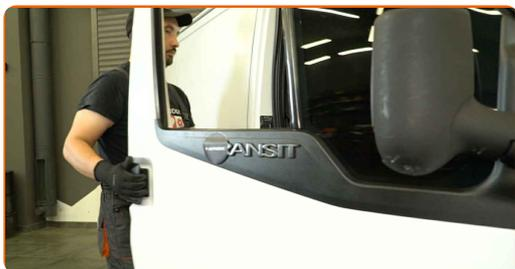
**2** Skruva loss dörrpanelens skruvar. Använd en phillipsmejsel.
