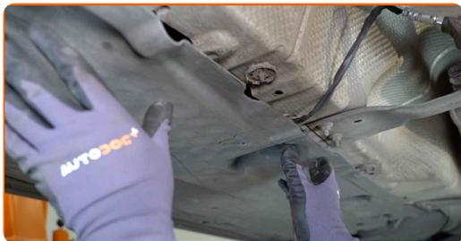
**19** Dra åt fästelementen på oljeträgets nedre lucka. Använd hylsnyckel Nr10. Använd en spärrnyckel.
