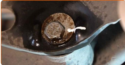
**8** Skruva loss tryckstångens fästelement från balken. Använd kombinyckel Nr 18. Använd hylsnyckel Nr18. Använd en spärrnyckel.
