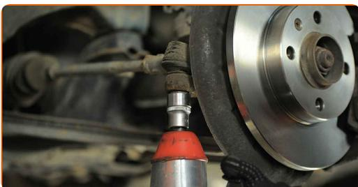
**11** Koppla bort parallellstagsändan från styrspindelns. Använd en kullad avdragare.
