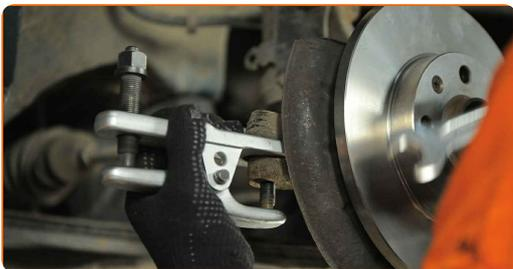
**12** Skruva loss änden från parallellstaget.
