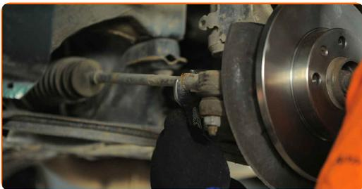
**9** Rengör fästningarna som kopplar styrstagänden till styrspindel. Använd en stålborste. Använd WD-40 aerosol.
