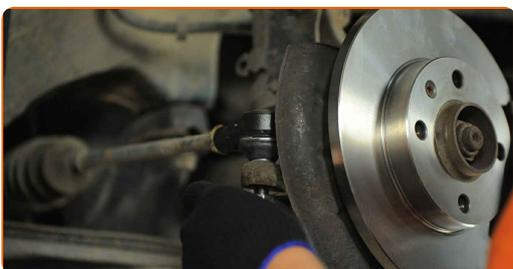
**16** Skruva åt fästande skruven som kopplar styrstagsände till styrspindel. Använd hylsnyckel Nr19. Använd en momentnyckel. Dra åt den till 35 Nm vridmoment.
