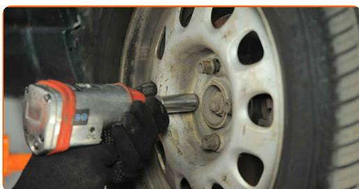
23 Sänk bilen och arbeta i omvänd ordning, dra åt hjulbultarna. Använd hjulmutterhylsor nr. 17 Använd en momentnyckel. Dra åt den till 120 Nm vridmoment.
