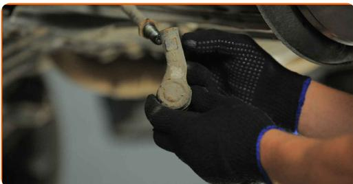
**13** Rengör monteringsställen av styrstagsände. Använd en stålborste. Använd WD-40 aerosol.
