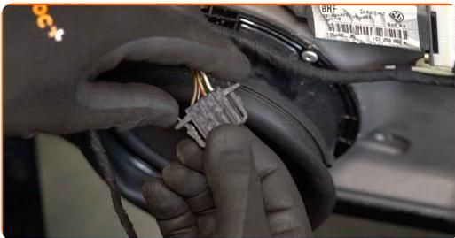
**15** Koppla loss fönsterhissens kabelknippe. Använd ett verktyg för panelclips.
