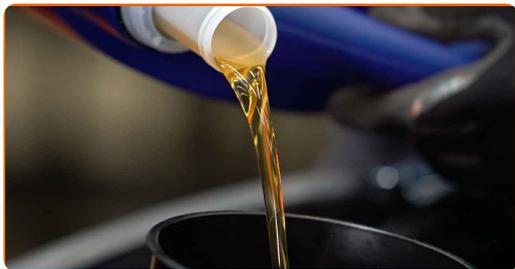
**19** Häll olja i motorn via påfyllningshålet. Den erforderliga mängden olja är: 3.8 l.
