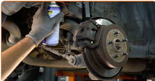
**11** Installera nya stång och dra åt fästelementen. Använd hylsnyckel Nr17. Använd en spärrnyckel.
