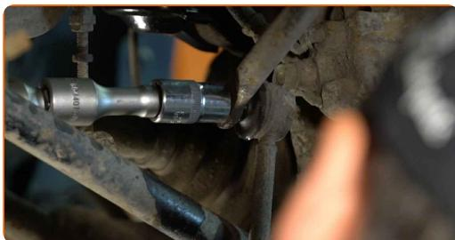
**8** Skruva loss fästena som håller fast krängningshämmaren med stötdämparen. Använd hylsnyckel Nr17. Använd en spärrnyckel.
