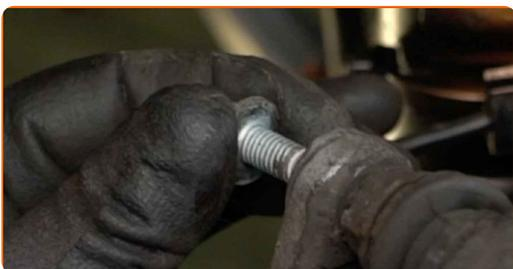
**21** Dra åt fästelementen till bromsoket. Använd kombinyckel Nr 17. Använd hylsnyckel Nr13. Använd en momentnyckel. Dra åt den till 34 Nm vridmoment.
