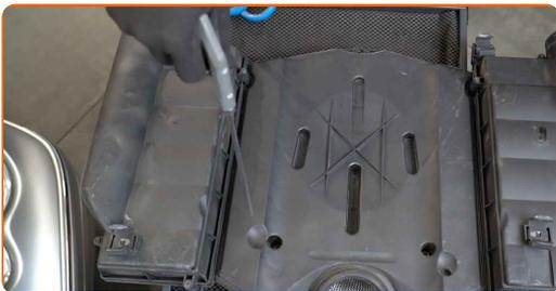
**9** Skruva loss fästena på luftfiltrets kåpor. Använd Torx T20. Använd en spärrnyckel.
