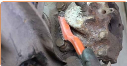
**14** Skruva loss bromsokets fästen. Använd hylsnyckel Nr16. Använd en spärrnyckel.
