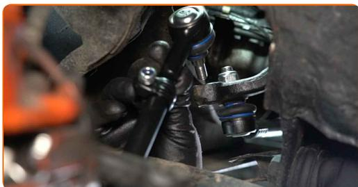
**31** Dra åt styrledens fästbult. Använd kombinyckel Nr 13. Använd hylsnyckel Nr13. Använd en momentnyckel. Dra åt den till 20 Nm vridmoment.
