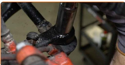
**19** Koppla bort styrleden från styrspindeln. Använd en kullad avdragare.
