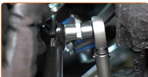
**32** Dra åt parallelstagsändens låsmutter. Använd kombinyckel Nr 22. Använd en momentnyckel. Dra åt den till 50 Nm vridmoment.
