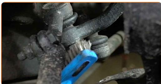
**17** Skruva loss muttern som fäster styrleden till styrspindeln. Använd hylsnyckel Nr17. Använd en spärrnyckel.
