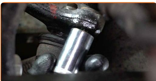
**13** Koppla bort styrleden från styrspindeln. Använd en kullad avdragare.
