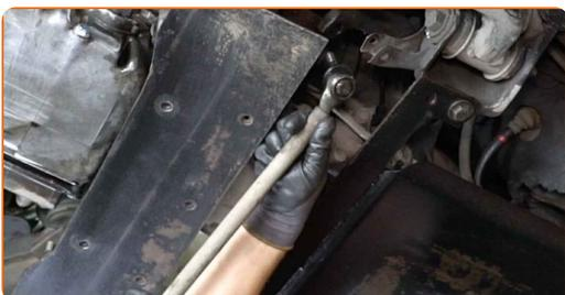
**26** Rengör monteringsfästena till parallellstaget och styrstagen. Använd en stålborste. Använd allrengöringssprej.
