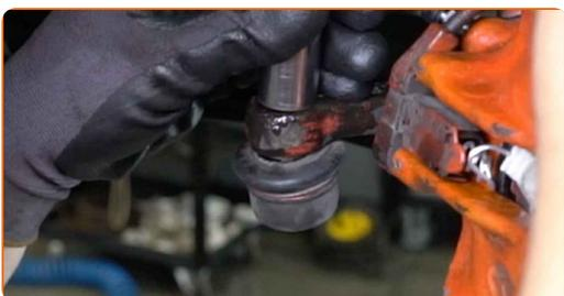
**12** Skruva loss fästet som kopplar ihop styrleden med hjälpstyrarmen. Använd hylsnyckel Nr17. Använd en spärrnyckel.
