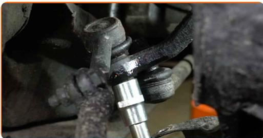
**18** Skruva loss fästet som kopplar ihop styrleden med hjälpstyrarmen. Använd hylsnyckel Nr17. Använd en spärrnyckel.
