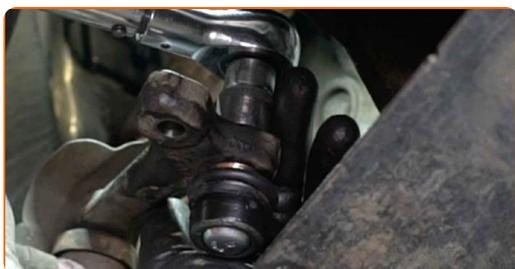
**29** Justera längden på de nya styrstagen, genom att använda de gamla som referens. Använd kombinyckel Nr 13. Använd kombinyckel Nr22 (2 delar). Använd hylsnyckel Nr13. Använd en spärrnyckel. Använd ett skjutmått.
