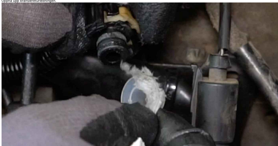
21 Anslut slangen till bränslereturledningen.
