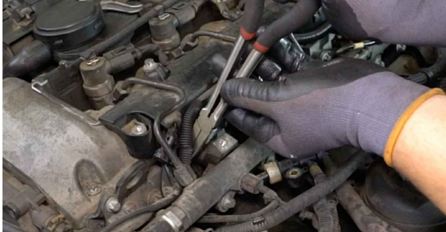
14 Behandla glödstiften. Använd värmebeständigt keramiskt fett.
