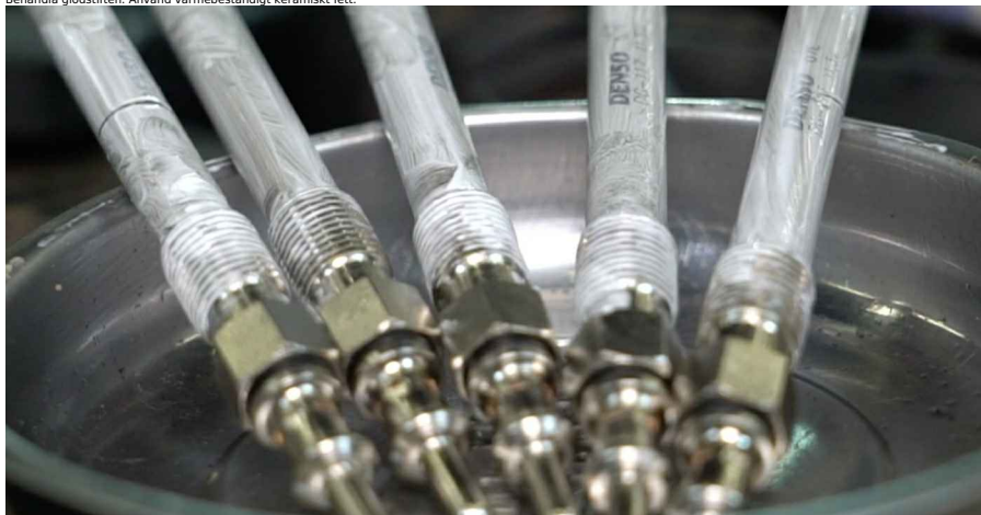
15 Installera nya glödstift i deras monteringsåsen. Användning spetsångar.
