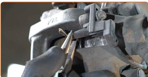
**10** Ta bort dammskyddskåporna från bromsokets styrstift. Använd en kofot.
