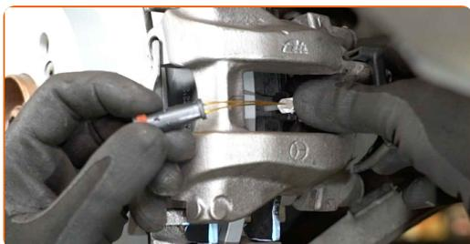
**37** Koppla tillbaka slitvarnarkontakten till bromsbelägget.
