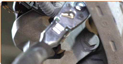
**12** Koppla av bromsokets fjäder. Använd en kofot.
