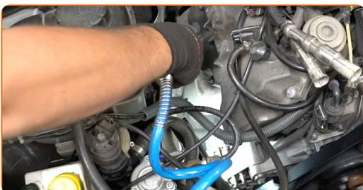
**13** Skruva ur tändstiften. Använd tändstiftsmutter nr. 16. Använd en spärrnyckel.
