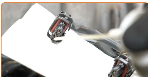
**22** Anslut kontakterna till tändspolarna. Försäkra dig om att du hör ett klick som indikerar att den har låsts på plats.
