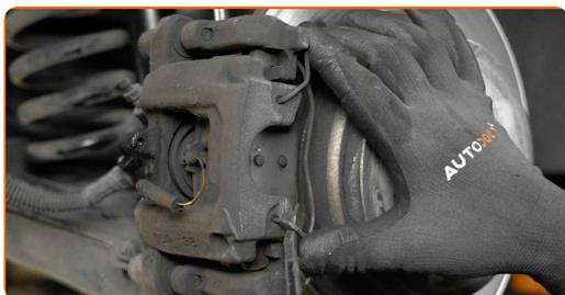
**13** Ta bort dammskyddskåporna från bromsokets styrstift. Använd en kofot.
