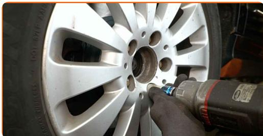
**38** Sänk bilen och arbeta i omvänd ordning, dra åt hjulbultarna. Använd hjulmutterhylsor nr. 17 Använd en momentnyckel. Dra åt den till 130 Nm vridmoment.
