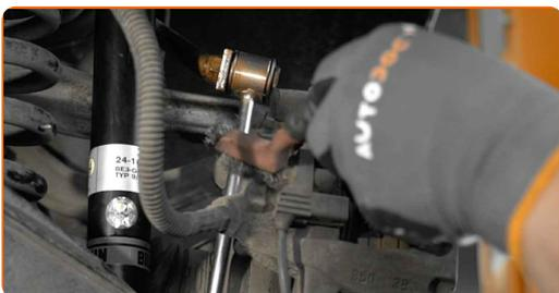
**9** Skruva loss fästena för kablaget till bromsbeläggens slitagevarnare. Använd Torx E10. Använd en spärrnyckel.
