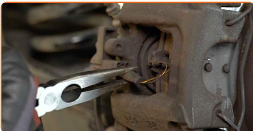
**8** Rengör fästena för kablaget till bromsbeläggens slitagevarnare. Använd en stålborste. Använd WD-40 aerosol.
