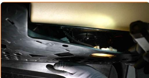
**7** Skjut kupéfiltrets hållare åt sidan för att lossa det.
