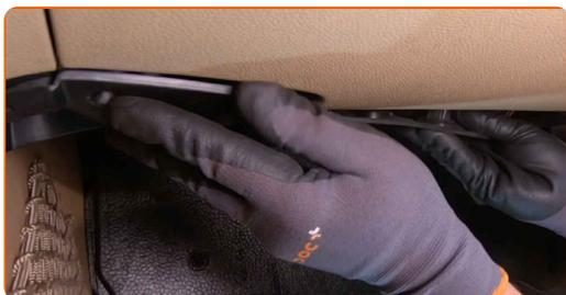
**12** Skruva fast panelfästen under handskfacket på passagerarsidan. Använd Torx T20.
