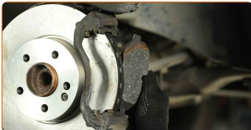
Utbyte: bromsbelägg – MERCEDES-BENZ SPRINTER 3-t Skåp (906).
