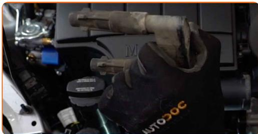
6 Skruva ur tändstiften. Använd tändstiftsmutter nr. 16. Använd en spärnyckel.
