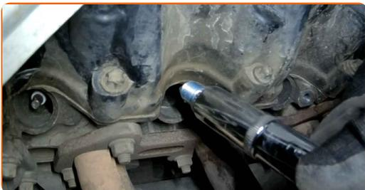
**10** Skruva fast och dra åt de nya tändstiften. Använd tändstiftsmutter nr. 16. Använd en momentnyckel. Dra åt den till 25 Nm vridmoment.
