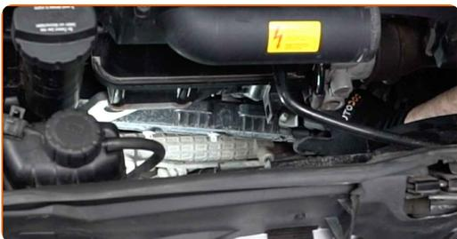
**4** Skruva loss tändspolens hållare. Använd hylsnyckel NrE11. Använd en spärrnyckel.
