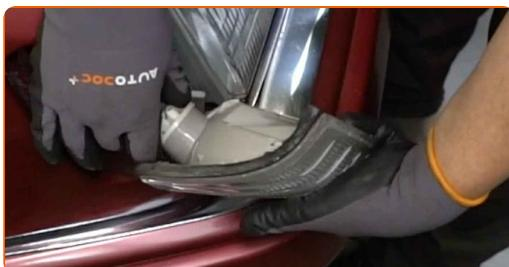
4 Koppla loss kontakten till blinkerslampan.
