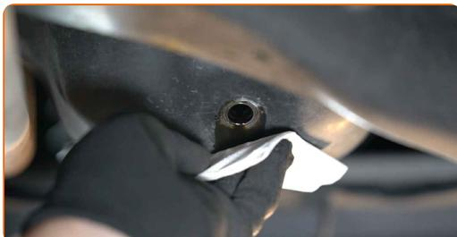
**6** Skruva i nya avtappningspluggen och dra åt den. Använd kombinyckel Nr 14. Använd en momentnyckel. Dra åt den till 25 Nm vridmoment.
