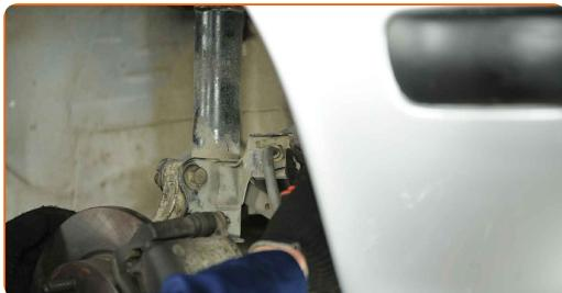
**7** Rengör fästenheterna som förbinder stötdämparen med styrspindeln. Använd en stålborste. Använd WD-40 aerosol.
