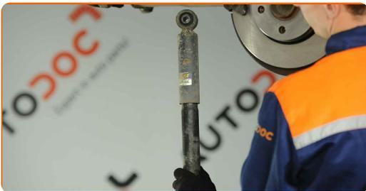
**13** Rengör stötdämparnas monteringsfästen. Använd en stålborste. Använd WD-40 aerosol.
