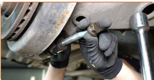
**10** Skruva loss övre fästelementet från stötdämparen. Använd hylsnyckel Nr18. Använd en spärrnyckel.
