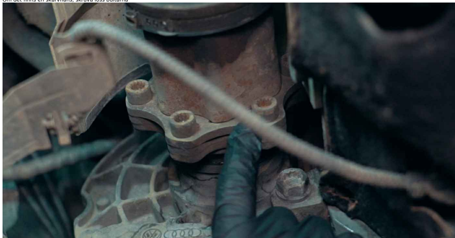
8 Om det finns en skarvfläns, skruva loss bultarna
