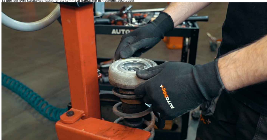
13 Ta bort det övre stötdämparfästet för att komma åt damasken och genomslagsstoppet
