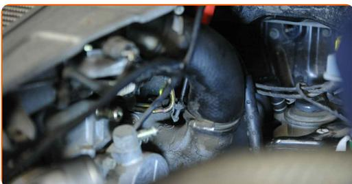
**25** Skruva fast fästbultarna på bränslefiltrets hållare. Använd hylsnyckel Nr10. Använd en spärrnyckel. Använd en Phillips skruvmejsel.
