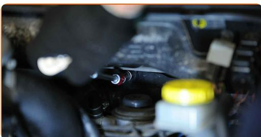
**26** Fäst vakuumröret. Använd en tång.
