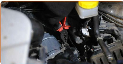
**24** Dra åt fästningsklamporna för bränsleslang. Använd en tång.
