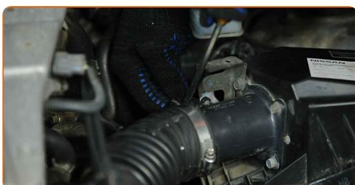
**8** Ta loss vakuümörret. Använd en tång.
