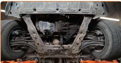
9 Sätta en spillolja behållare med minst 5 l kapacitet under dränering hålet.
