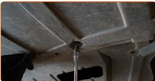
8 Ta bort locket till oljetråget. Använd hylsnyckel Nr10. Använd en plattmejsel.
