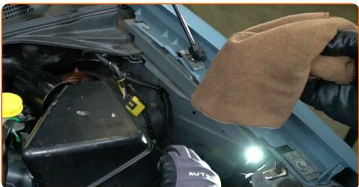
**9** Installera den nya filterdelen i filterhuset. Kontrollera att filtret kanten passar tigt till huset.
