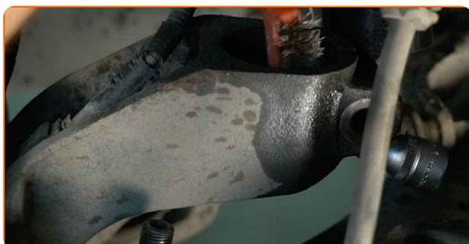
38 Justera fjäderbenet på styrspindeln.
