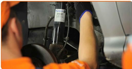
14 Koppla loss styrspindeln från fjäderbenet. Använd en gummihammare.
