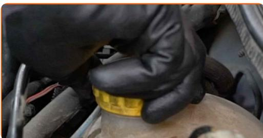
38 Kör motorn i några minuter. Detta bör göras för att ta bort överbliven luft från kylsystemet och för att kontrollera att komponenterna fungerar som de ska.
