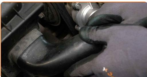
**32** Fäst klämman på luftfiltrets insugsslang.
