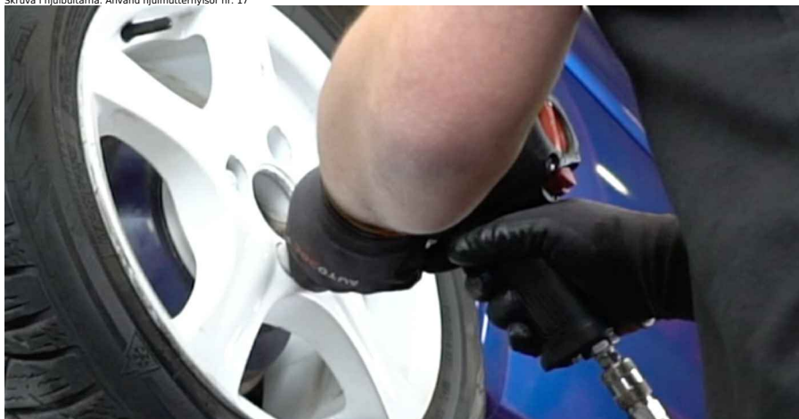
47 Skruva i hjulbultarna. Använd hjulmutterhylsor nr. 17
