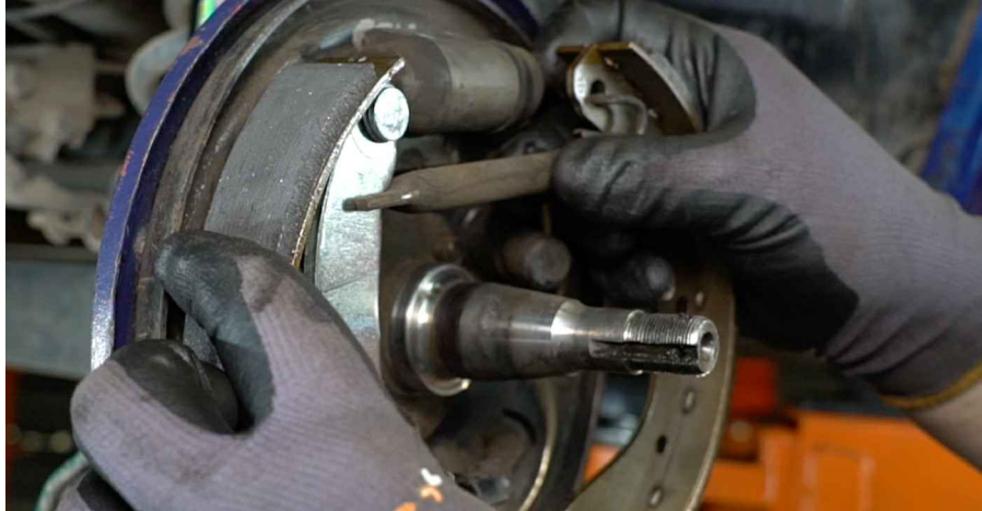
37 Montera den nedre retur fjädern.
