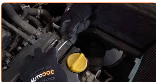
**4** Skruva loss tändspolens hållare. Använd Torx T30. Använd en spärrnyckel.
