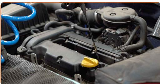
**8** Skruva ur tändstiften. Använd tändstiftsmutter nr. 16. Använd en spärnyckel.
