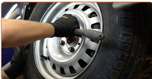
**30** Sänk bilen och arbeta i omvänd ordning, dra åt hjulbultarna. Använd en momentnyckel. Dra åt den till 110 Nm vridmoment.
