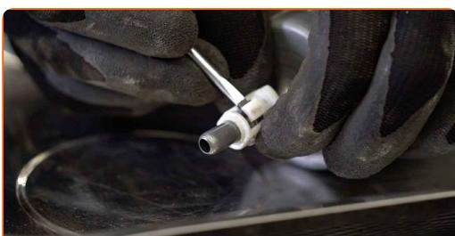
**8** Installera spärrarna för fästningarna på bränslefiltrets slangar.
