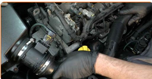
**17** Sätt fast klämman på luftintagsslangen. Använd hylsnyckel Nr7. Använd en spärrnyckel.
