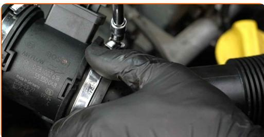
**18** Skruva i fästet till luftintagsröret. Använd Torx T25.
