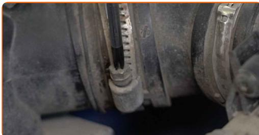
5 Täck över luftintagets slang med en mikrofiberduk för att skydda den från att smuts kommer in i systemet.
