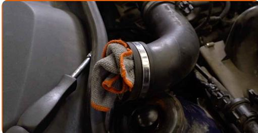
**7** Lossa fästelementen som förbinder luft röret och ledningsnätet till luftfilter huset.
