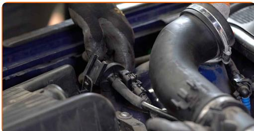
**8** Ta av filterlocket. Avlägsna filterdelen från filterhuset.
